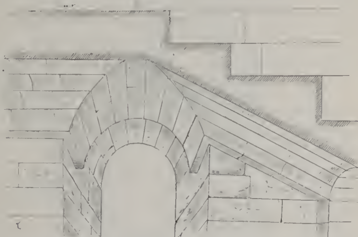
Fig. 195. Gewölbeanlagen im Odeion des Herodes zu Athen.
